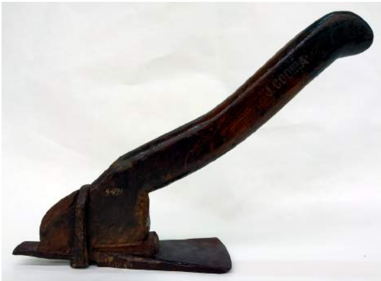
Aixa, aja o azuela (siglo XIX). Característica herramienta de construcción naval que dio nombre a los maestros constructores en la costa catalana. ( Museu Marítim de Barcelona ).
