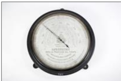
Baròmetre aneroide per predir el temps a les Filipines. Construït l'any 1886 pel jesuïta Federico Faura (1840-1897). Les Filipines es troben en la zona afectada pels monsons, que poden desencadenar tempestes terribles. NR 7891
